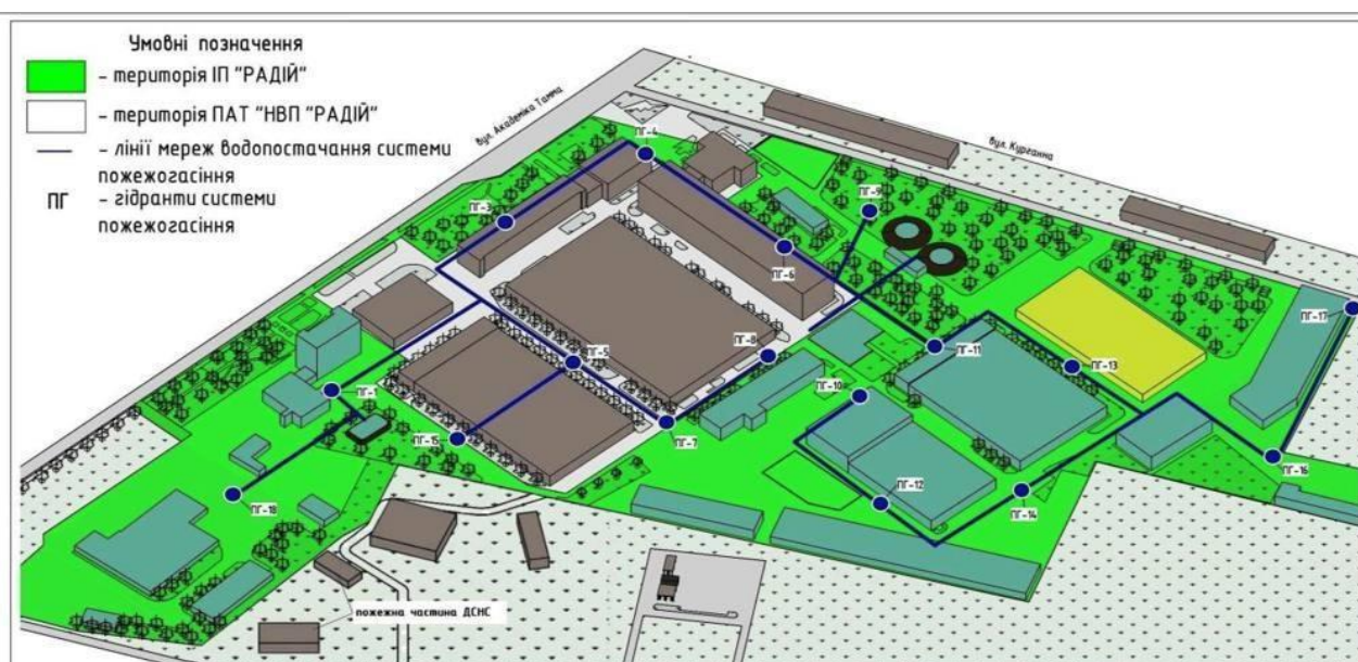
Мал.8 Схема розташування мереж та об'єктів системи пожежогасіння
