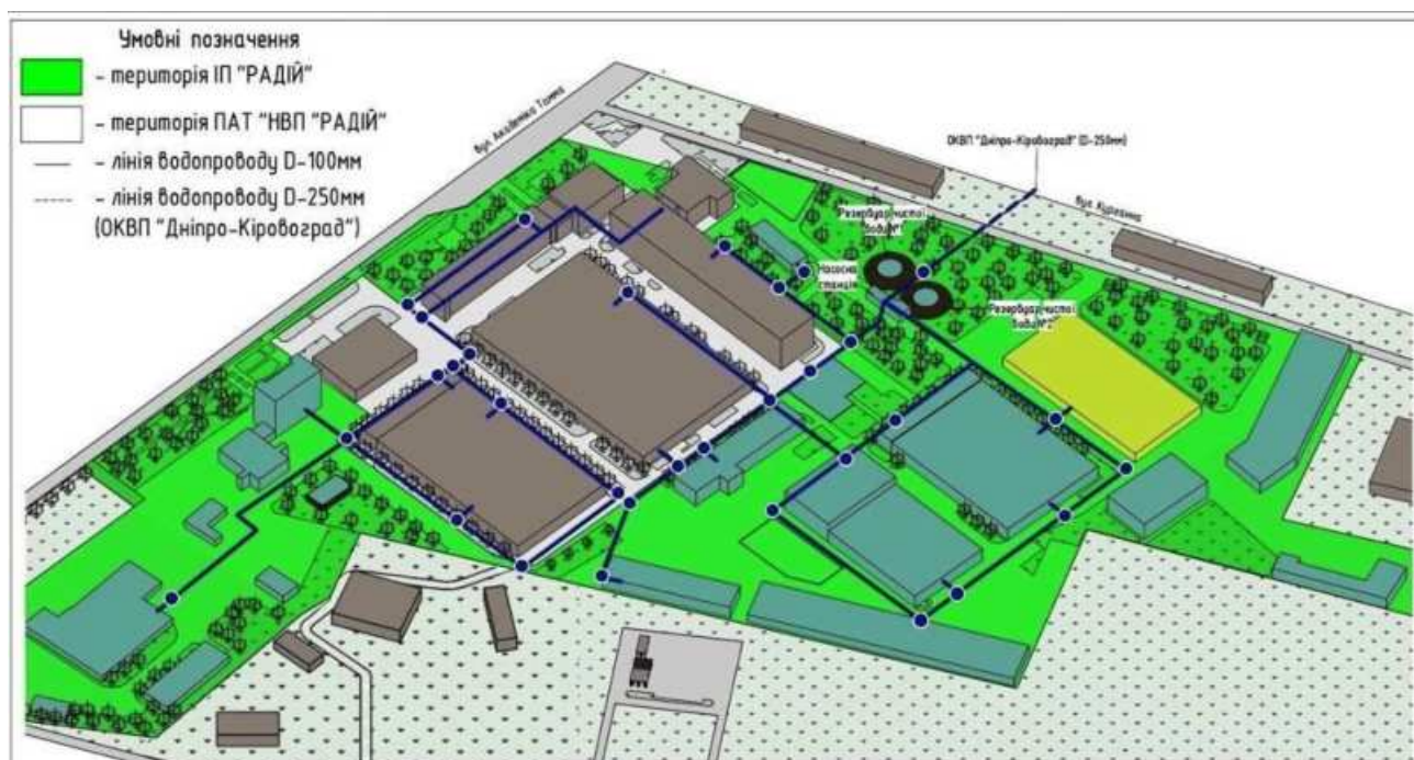
Мал. 5. Схема розташування мереж і об'єктів системи водопостачання
